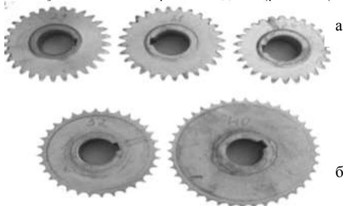
**Рисунок 8 – Сменные шестерни (а) и звездочки (б)**
