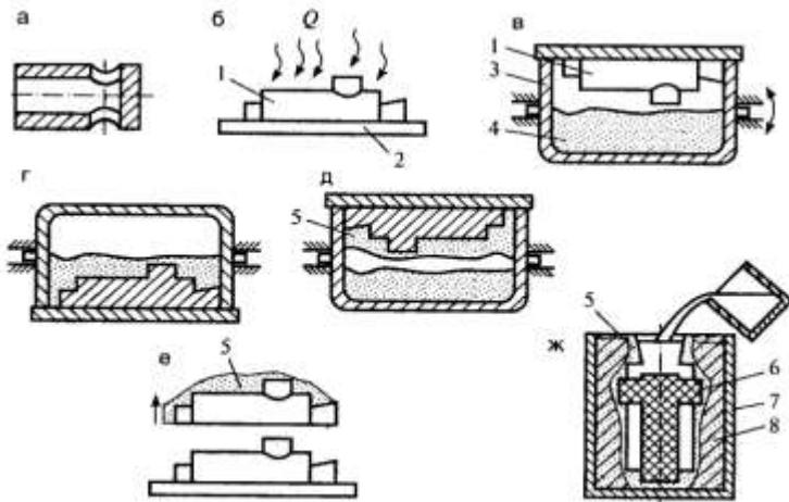
*Рис. 2.2. Последовательность операций формовки при литье в оболочковые формы: а – деталь; б – нагревание модели; в – установка модели на ящике со смесью; г – выдержка смеси на модели; д – удаление непрогретой смеси; е – удаление корковой полуформы; ж – сборка и заливка формы*
