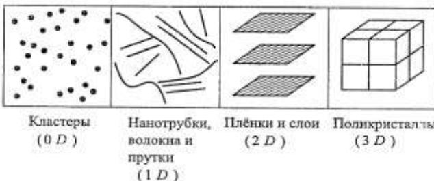
*Рис. 11.3. Типы нанокристаллических материалов:*
