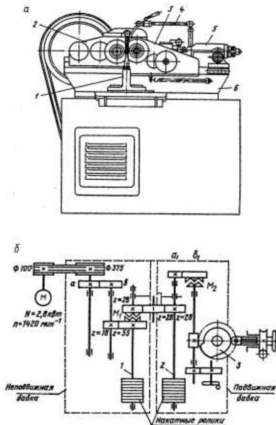
Рис. 6.2. Резьбонакатной полуавтомат модели 5933 (а) и его кинематическая схема (б)
