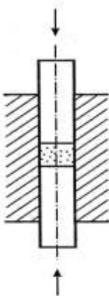
Рис. 7.2. Схема двустороннего прессования порошковых материалов
