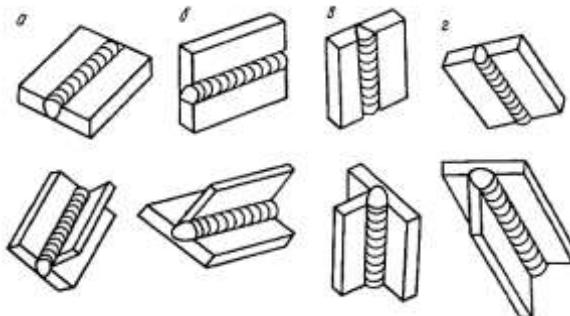
Рис. 8.3. Пространственное положение стыковых и угловых сварных швов: а – нижнее; б – горизонтальное; в – вертикальное; г – потолочное
