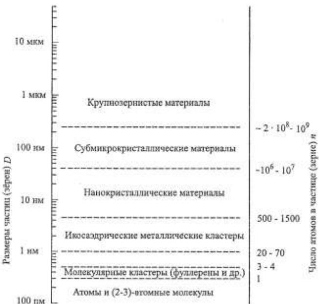
Рис. 11.2. Классификация веществ и материалов по размеру  $D$  частиц (зерен)
