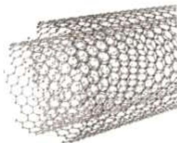
*Рис. 11.4. Компьютерная графическая модель двухслойной углеродной нанотрубки со спиральным расположением шестиугольных колец атомов углерода*
