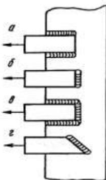
Рис. 8.2. Виды сварных швов по отношению к направлению действующих усилий: а – фланговый; б – лобовой; в – комбинированный; г – косой
