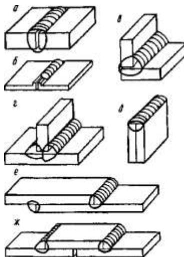
*Рис. 8.1. Типы сварных соединений: а –стыковое; б – стыковое с отбортомкой; в – угловое; г – тавровое; д – торцевое; е – нахлестанное; ж – с накладкой*
