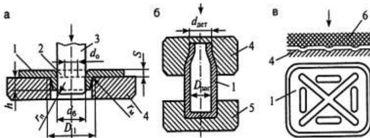
Рис. 5.3. Схемы формообразующих операций: а – отбортовка; б – обжим; в – формовка. 1 – изделие; 2 – заготовка; 3 – пuhanсон; 4 – матрица; 5 – подставка-упор; 6 – резиновая подушка
