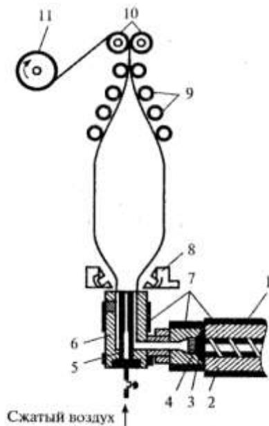
*Рис. 9.3. Схема изготовления пленки раздуванием трубы вверх:*
