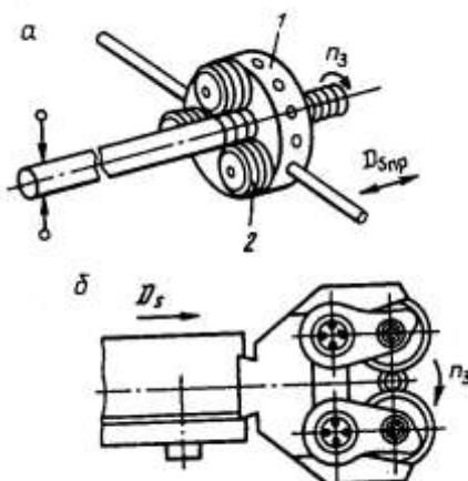
Рис. 6.4. Резьбонакатные головки
