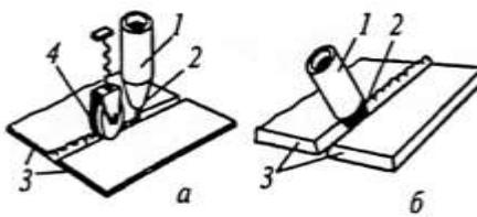
*Рис. 8.11. Схема бесконтактной (а) и контактной (б) экструзионной сварки расплавом: 1 – экструдер; 2 – мундштук экструдера; 3 – свариваемые детали; 4 – прокатывающий ролик*
