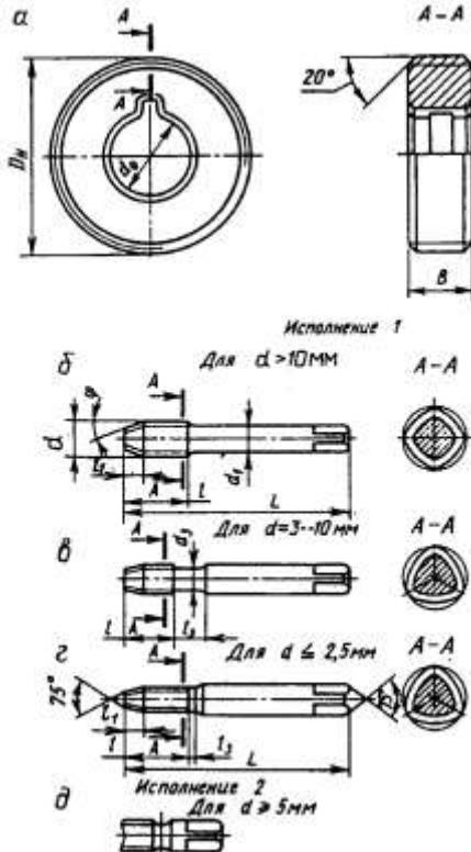
Рис. 6.3. Резьбонакатной инструмент: а – ролик;
