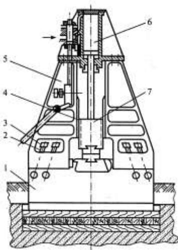
*Рис. 4.8. Паровоздушный штамповочный молот: 1 – шабот; 2 – пружины; 3, 5 – стойки; 4 – направляющие; 6 – подвижная часть*
