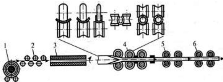
*Рис. 3.8. Схема производства труб непрерывной печной сваркой:*
