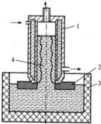
*Рис.2.7. Литье вакуумным всасыванием*
