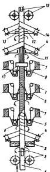
*Рис. 10.6. Схема вертикальной установки для формования труб на движущейся оправке*
