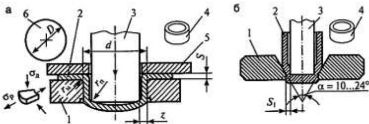
Рис. 5.2. Схемы вытяжки без утонения (а) и с утонением (б):
