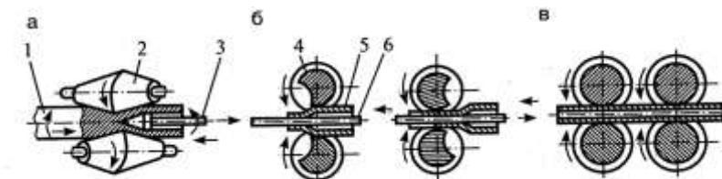
*Рис. 3.6. Схема прокатки бесшовных труб на трубопрокатной установке с пилигримовым станом: а – прошивной стан; б – пилигримовый стан; в – калибровочный стан;*
