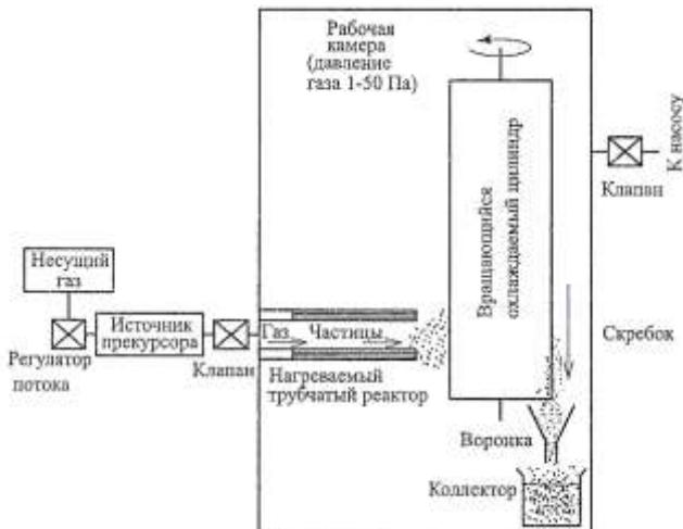
*Рис. 11.7. Схема аппаратуры для получения нанокристаллических керамических порошков методом конденсации паров с использованием металлоорганических прекурсоров как источника конденсируемого пара*
