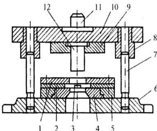
Рис. 5.5. Штамп для вырубки: 1 – съемник; 2 – направляющие планки; 3 – упор; 4 – матрица; 5 – матрица-держатель; 6 и 10 – нижняя и верхняя плиты; 7 – направляющие колонки; 8 – направляющие втулки; 9 – пuhanсонодержатель; 11 – хвостовик; 12 – пuhanсон
