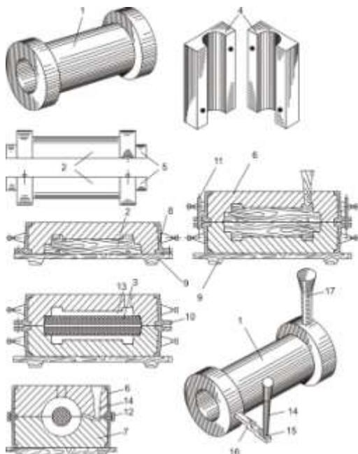
*Рис. 2.1 Последовательность изготовления чугунной отливки втулки: 1 – чертеж втулки; 2 – деревянная модель; 3 – стержень; 4 – стержневой ящик; 5 – стержневые знаки; 6 – верхняя полуформа; 7 – нижняя полуформа; 8 – опока; 9 – подопечный щиток; 10 – втулки; 11 – центрирующие штыри; 12 – скобы; 13 – полость формы; 14 – стояк; 15 – шлакоуловитель; 16 – питатель; 17 – выпуск*
