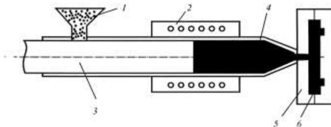
*Рис. 9.6. Схема литья под давлением: 1 – гранулят; 2 – электронагреватели; 3 – поршень (плунжер); 4 – расплав; 5 – пресс-форма; 6 – отливка*
