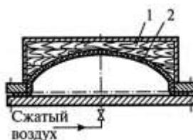
*Рис. 9.11. Схема пневматического прессования: 1 – матрица; 2 – изделие*
