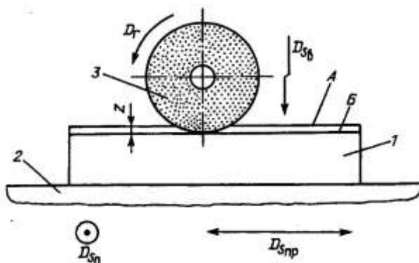
*Рис.6.5. Схема обработки заготовки на плоскошлифовальном станке:  $D_1$  – главное движение резания;  $D_{Snp}$ ,  $D_{Sб}$ ,  $D_{Sn}$  – соответственно продольное, вертикальное и поперечное перемещение подачи; А – обрабатываемая поверхность; Б – обработанная поверхность, с которой снят припуск  $z$ .*
