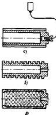
Рис. 10.2. Рифленые валки: а – с продольными канавками; б – с кольцевыми канавками; в – из перфорированного листа
