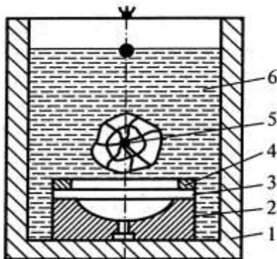
Рис. 5.10. Схема штамповки взрывом: 1 – бассейн; 2 – матрица; 3 – заготовка; 4 – прижим; 5 – заряд; 6 – вода
