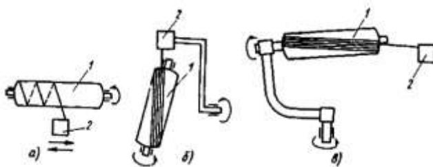
*Рис. 10.5. Типы намоточных станков: а – с возвратно-поступательным движением раскладчика; б – с вращением раскладчика; в – с неподвижным раскладчиком и вращающейся в двух плоскостях оправкой.*
