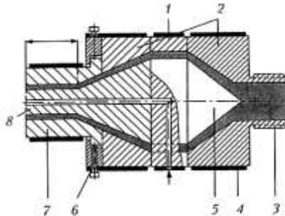
*Рис. 9.2. Дорн экструзионной головки для производства труб:*
