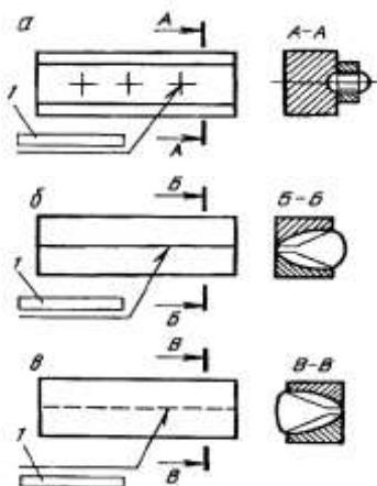
*Рис. 8.10. Условные изображения видимых и невидимых швов сварных соединений: а – видимый электrozаклепочный; б – видимый стыковой односторонний; в – невидимый стыковой односторонний; 1 – условное обозначение шва по ГОСТу*
