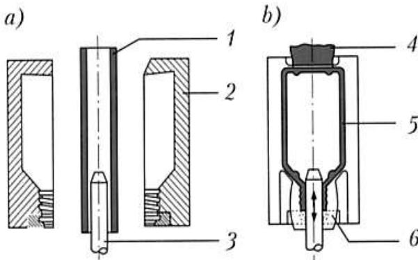
Рис. 9.5. Раздувная форма с раздувным дорном: а – форма открыта; б – форма закрыта; 1 – рукав; 2 – форма; 3 – раздувной дорн; 4 – отжимной участок рукава; 5 – бутылка; 6 – калибровка горловины
