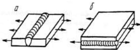
Рис. 8.7. Сварные швы: а – рабочие, б – связующие
