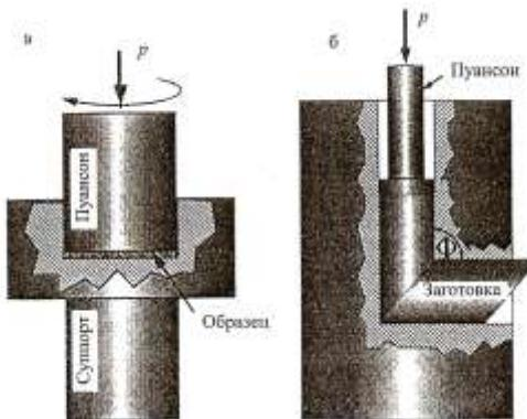
Рис. 11.12. Схемы основных методов интенсивного пластического деформирования: а – кручение под высоким давлением; б – равноканальное угловое прессование
