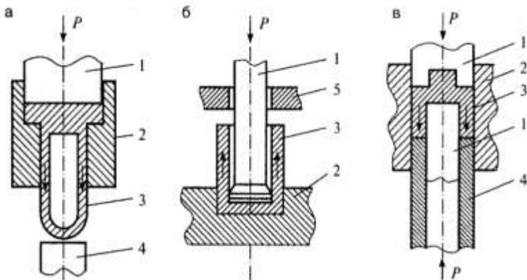
*Рис. 4.11. Схемы способов холодного выдавливания:
