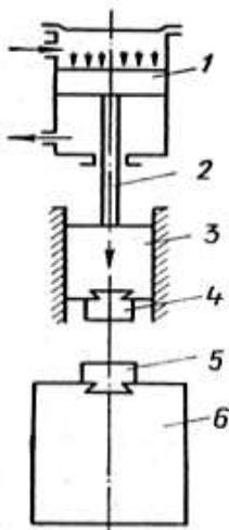
Рис. 4.4. Схема паровоздушного молота двустороннего действия: 1 – поршень; 2 – шток; 3 – баба; 4 – верхний боек (штамп); 5 – нижний боек (штамп); 6 – шабот
