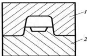
*Рис. 4.6. Штамповка в закрытом штампе: 1, 2 – верхняя и нижняя части штампа*
