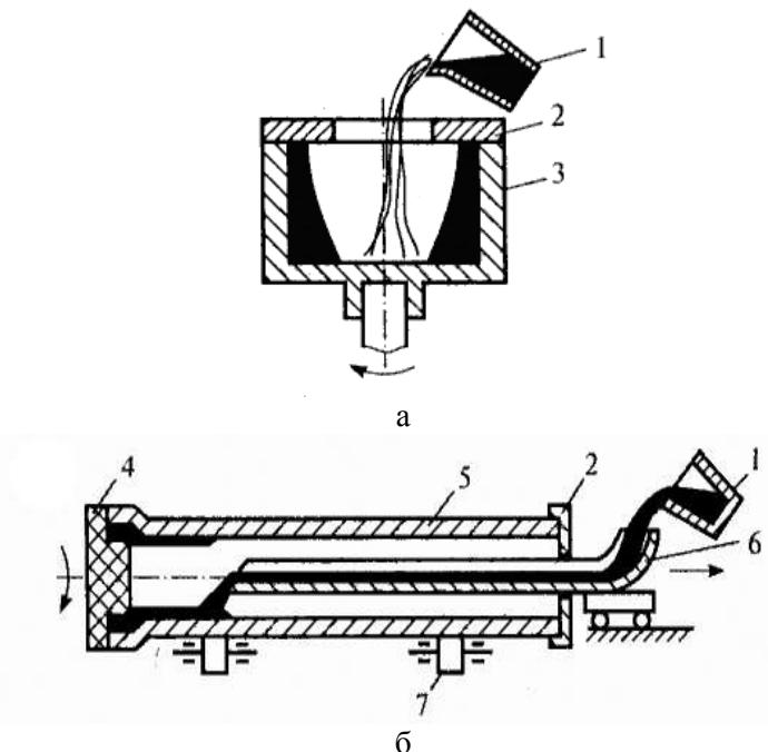
*Рис. 2.5. Центробежное литье: а – вертикальная ось вращения; б – горизонтальная ось вращения*
