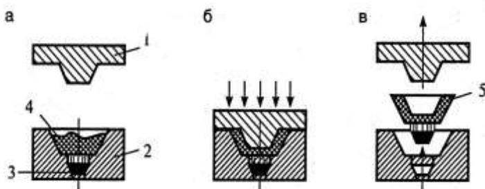
Рис. 9.10. Схема прессования: а – загрузка шихты; б – прессование; в – извлечение изделия; 1 – пуансон; 2 – матрица; 3 – выталкиватель; 4 – пресс-материал; 5 – готовое изделие
