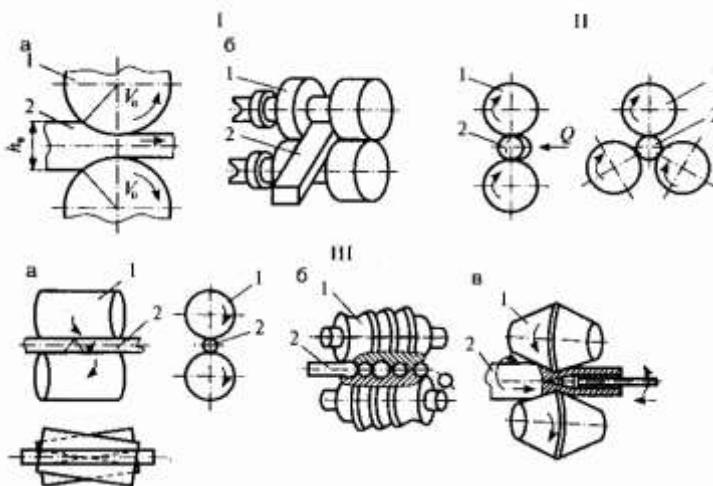
Рис. 3.1.Основные виды прокатки: I – продольная прокатка; а – в гладких валках; б – в калибрах; II – поперечная прокатка; III – поперечно-винтовая прокатка: а – в гладких валках; б – в спиральных валках; в – винтовая (косая) прокатка труб
