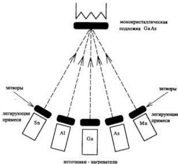
*Рис. 11.5. Схема установки для молекулярно-лучевой эпитаксии: выращивание пленки твердого раствора алюминий-галлий-мышьяк на подложке GaAs*
