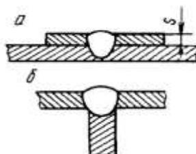
Рис. 8.8. Проплавные швы: *а* – нахлесточного соединения; *б* – таврового соединения; *s* – толщина проплавляемой детали
