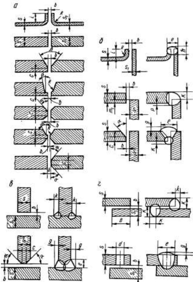
Рис. 8.9. Элементы геометрической формы подготовленных кромок под сварку: а –стыковых швов; б – угловых; в – тавровых; г – нахлесточных швов; б – зазор; В – размер нахлестки; с – притупление; д – диаметр отверстия; е – ширина шва; к – катет шва;  $m_1$  – величина смещения кромок;  $S$  и  $S_1$  толщина металла;  $q$  – выпуклость шва;  $\alpha$  – угол скоса кромки;  $\beta$  – угол разделки кромок
