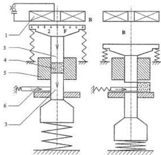
Рис. 11.10 . Схема одноосного магнитно-импульсного прессования нанопорошков: а – стадия сжатия; б – стадия выемки готового образца; 1 – индуктор; 2 – концентратор; 3 – верхний и нижний пuhanсоны; 5 – матрица; 6 – устройство выемки образца
