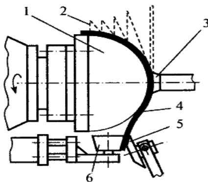
*Рис. 5.9. Схема ротационной вытяжки полусферы: 1 – оправка; 2 – последовательность процесса; 3 – прижимная бабка; 4 – заготовка; 5 – давильный ролик; 6 – поддерживающие ролики*
