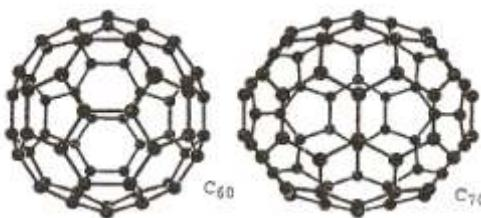
*Рис. 11.8. Структура фуллеренов C<sub>60</sub> и C<sub>70</sub>*
