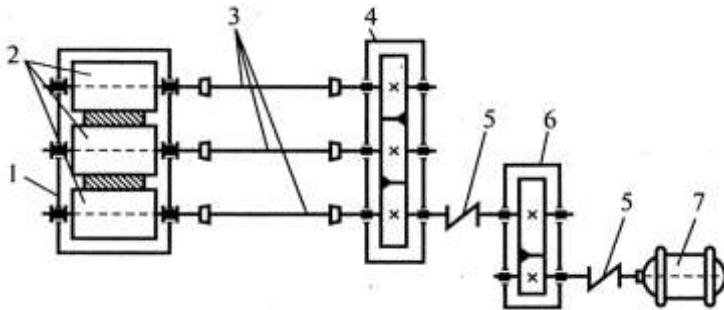
Рис. 3.2. Кинематическая схема прокатного стана: 1 – рабочая клеть, 2 – валки, 3 – шпинделы, 4 – шестеренная клеть, 5 – муфты, 6 – редуктор, 7 – электродвигатель
