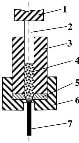
Рис. 7.4. Схема мундштучного прессования: 1 – плунжер гидравлического пресса; 2 – пuhanсон; 3 – стальной стакан; 4 – порошок; 5 – мундштук; 6 – матрица; 7 – заготовка
