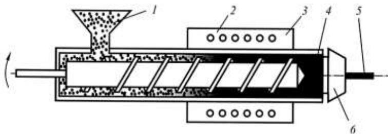
Рис.9.1. Схематическое изображение экструдера
