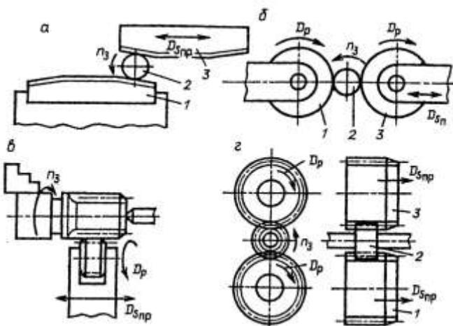
Рис. 6.1. Схемы формообразующего накатывания
