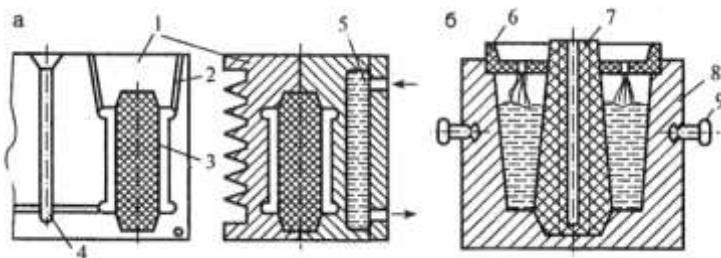
*Рис. 2.4. Конструкция кокилей: а – разъемный кокиль; б – вытряхной кокиль; 1 – полуформы; 2 – вентиляционные канавки; 3 – стержни; 4 – литниковые каналы; 5 – полости для охлаждения; 6 – заливочная чаша; 7 – стержень; 8 – вытряхной кокиль; 9 – опорные цапфы.*
