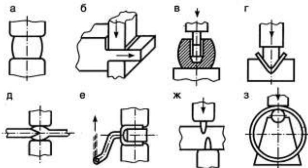
*Рис. 4.1. Схема основных операций машинной ковки: а – осадка; б – протяжка; в – прошивка; г – гибка; д – сварка; е – скручивание; ж – отрубка; з - раскатка*
