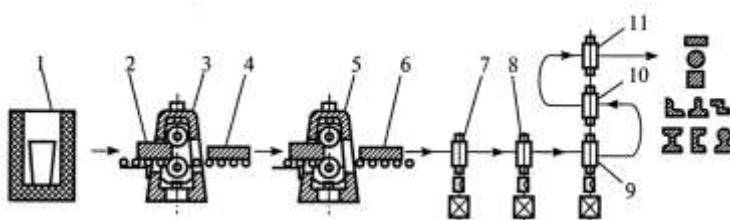
*Рис. 3.4. Схема прокатного производства сортового проката: 1 – нагревательный колодец; 2 – слиток; 3 – блюминг; 4 – блюм; 5 – заготовочный стан; 6 – блюм меньшего сечения; 7, 8, 9, 10, 11 – клети сортопрокатного стана*
