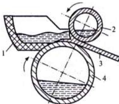
Рис. 2.9. Литье методом жидкотекущей прокатки
