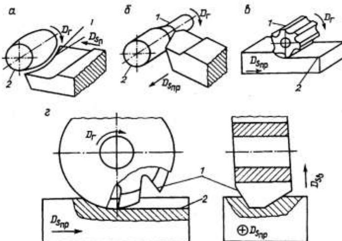
*Рис. 6.6. Схемы формообразования поверхностей деталей*
