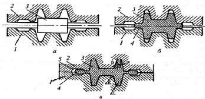
*Рис. 4.5. Штамповка в открытом штампе: а – начальная стадия; б – стадия образования заусенца; в – конечная стадия штамповки; 1, 2 – нижняя и верхняя половины штампа; 3 – исходная заготовка; 4 – заусенец; 5 – заусеничная канавка*
