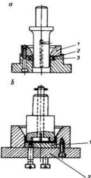
Рис. 5.7. Штампы для вытяжки со съемником (а): 1 – матрица; 2 – пружина; 3 – съемник; и выталкивателем (б): 1 – выталкиватель; 2 – нижняя плита штампа
