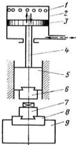
Рис. 4.3. Схема паровоздушного молота одностороннего действия: 1 – отверстие для прохода воздуха; 2 – рабочий цилиндр; 3 – поршень; 4 – шток; 5 – баба; 6 – верхний боек (штамп); 7 – нижний боек (штамп), 8 – штамповальная подушка; 9 – шабот
