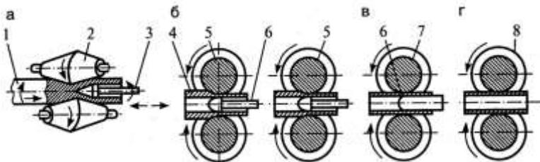
*Рис. 3.7. Схема прокатки бесшовных труб на трубопрокатной установке с автоматическим станом: а – прошивной стан; б – автоматический стан; в – обкатной стан; г – калибровочный стан; 1 – заготовка; 2 – валки; 3 – игла; 4 – труба; 5 – круглые калибры; 6 – оправка; 7 – обкатные валки; 8 - калибровочные валки*
