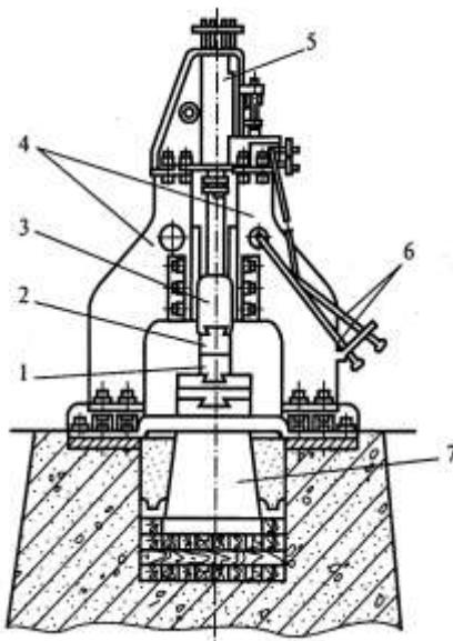
*Рис. 4.2. Паровоздушный ковочный молот арочного типа:*
