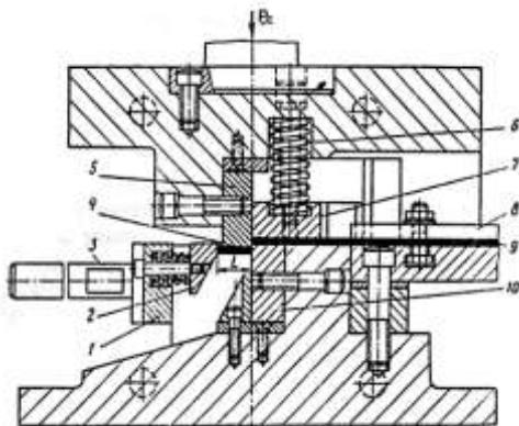
*Рис. 5.4. Штамп для отрезки с прижимом: 1 – каретка; 2 – упор; 3 – стержень; 4 – заготовка; 5 – пуансон-нож; 6 – пружина; 7 – прижим; 8 – планки; 9 – полоса (лента); 10 – матрица-нож*
