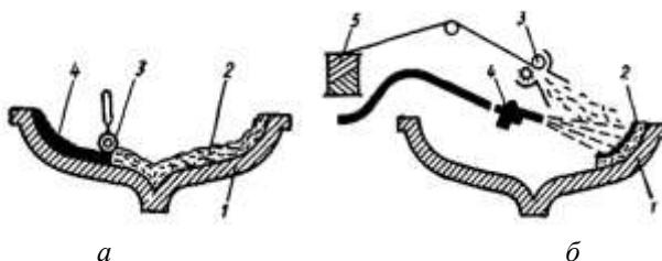
*Рис. 10.1. Схемы формообразования стеклопластиков методами контактного формования (а) и напыления (б)*
