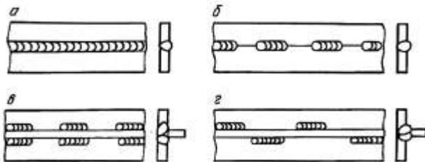
Рис. 8.6. Виды сварных швов по протяженности: а – сплошной; б – прерывистый; в – цепной прерывистый; г – шахматный прерывистый
