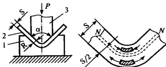
*Рис. 5.1. Схема гибки: 1 – матрица; 2 – заготовка; 3 – пuhanсон; NN – нейтральный слой;  $\alpha$  – угол, на которыйгибается заготовка*
