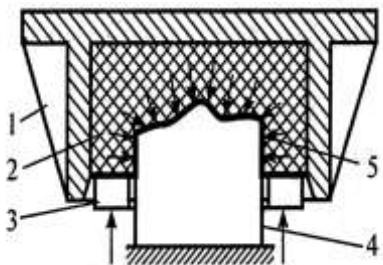
*Рис. 5.8. Схема вытяжки эластичной матрицей: 1 – контейнер; 2 – подушка; 3 – прижим; 4 – пuhanсон; 5 – заготовка*
