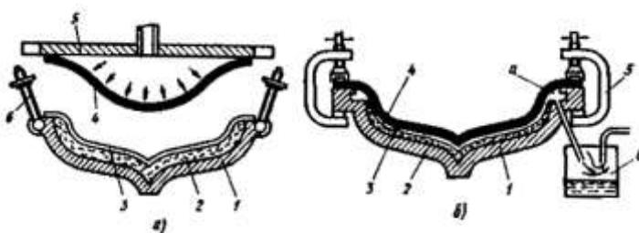
*Рис. 10.3 .Схемы формования изделий из стеклопластиков с помощью эластичной диафрагмы: а – под давлением; б – под вакуумом.*
