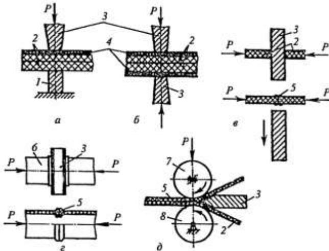
*Рис. 8.12. Сварка нагретым инструментом: 1 – опора; 2 – свариваемые листы; 3 – нагретый инструмент; 4 – изоляционная прокладка; 5 – сварной шов; 6 – свариваемые трубы; 7 – ведущий ролик; 8 – ролик-опора*
