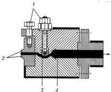
Рис. 9.4. Плоскощелевая головка: 1 – регулировочные винты; 2 – губки; 3 – упругий элемент дросселя; 4 – распределительный канал
