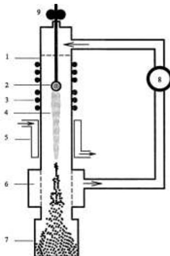
Рис. 11.6. Схема получения высокодисперсных металлических порошков в левитационно-струйном генераторе: 1 – испаритель; 2 – капля; 3 – индуктор; 4 – аэрозоль; 5 – холодильник; 6 – фильтр; 7 – контейнер; 8 – насос; 9 – механизм подачи проволоки
