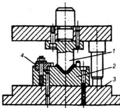
*Рис. 5.6. Схема штампа для гибки с регулируемым упором:*
