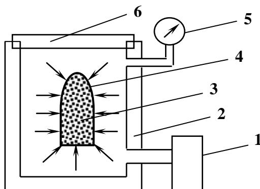
*Рис. 7.3. Схема установки для гидростатического формования порошка: 1 – гидронасос высокого давления; 2 – камера прессования (гидростат); 3 – порошок; 4 – эластичная оболочка; 5 – манометр; 6 – крышка*
