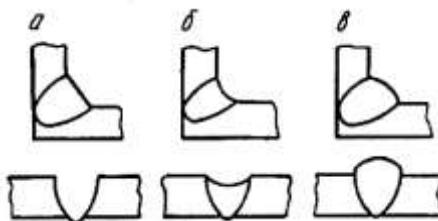
Рис. 8.4. Виды сварных швов по типу усиления:
