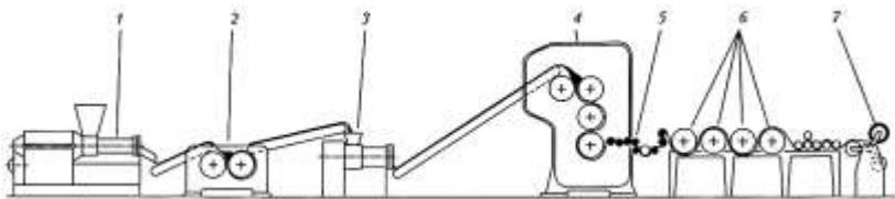
*Рис. 9.8. Технологическая схема для получения листов (пленок) из пластифицированного ПВХ на каландре: 1 – экструдер; 2 – смесительные вальцы; 3 – инековый пресс с фильтром; 4 – F – образный каландр; 5 – приемное устройство; 6 – охлаждающие валки; 7 – участок намотки листов (пленки).*
