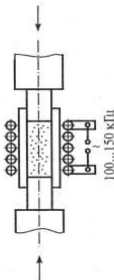
Рис. 7.5. Схема двухстороннего горячего прессования порошковых материалов с нагревом
