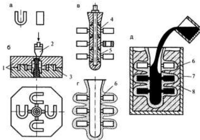
*Рис. 2.3 Литье по выплавляемым моделям: а – деталь; б – изготовление блока моделей; в – сборка блоков; г – нанесение покрытия; д – заливка формы. 1 – пресс-форма; 2 – шприц; 3 – модельная композиция; 4 – блок; 5 – металлический стержень; 6 – оболочковая форма; 7 – опока; 8 – песок*
