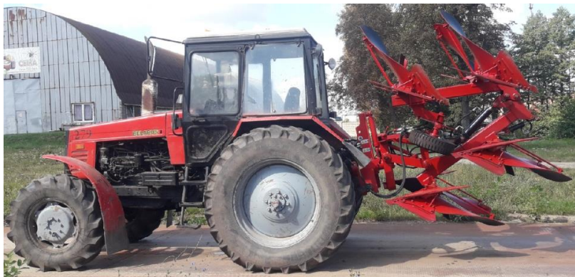
Рисунок 2 – Плуг ПОНС-4-40 в транспортном положении
