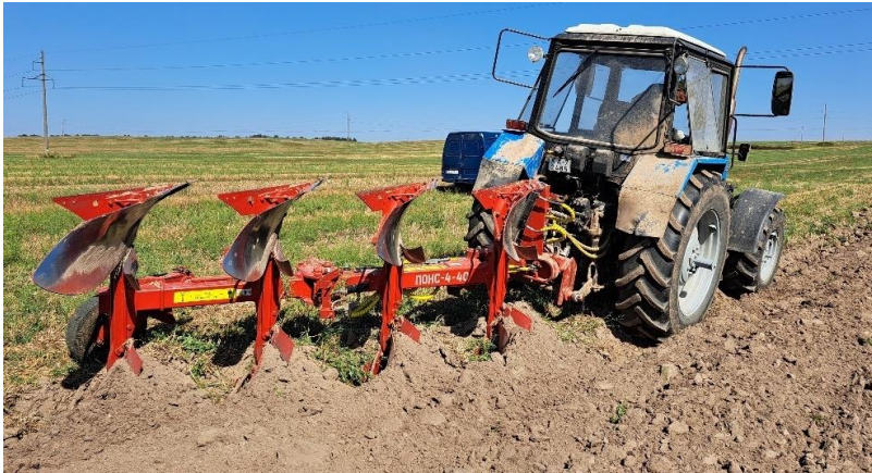
Рисунок 3 – Плуг ПОНС-4-40 в работе
