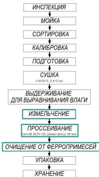
Рисунок 1 – Схема получения ягодного порошка
