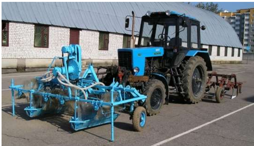
Рисунок – Общий вид комбинированного агрегата со щеточно-лопастными рабочими органами
