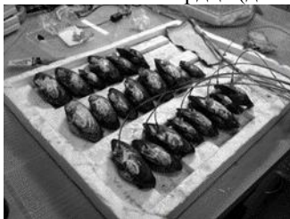
Рис. 1. Моллюски беззубки с закрепленным на одной из створок волоконно-оптическим датчиком для измерения кардиоактивности
