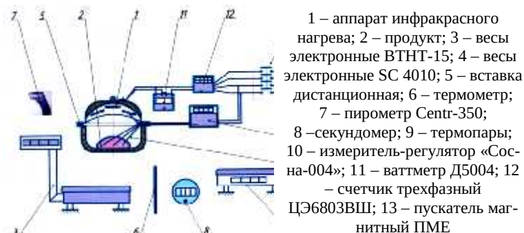
Рисунок 1 – Схема экспериментальной установки
