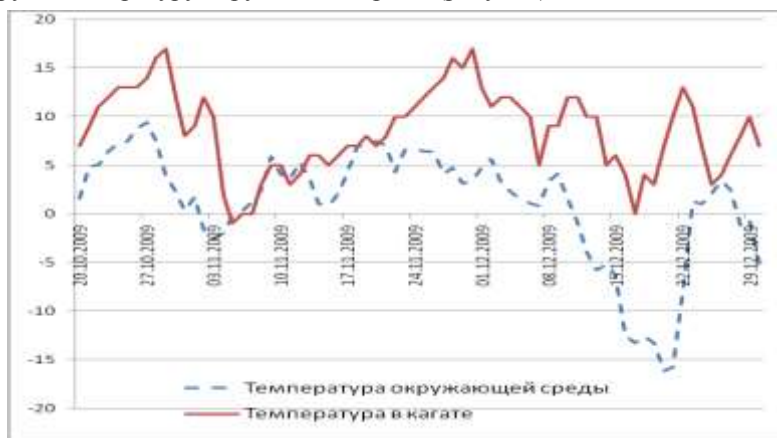
Рисунок – Изменение температуры воздуха в кагате в зависимости от температуры окружающей среды
