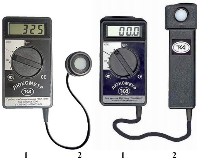
1) – блок обработки сигналов; 2) – фотометрическая головка
