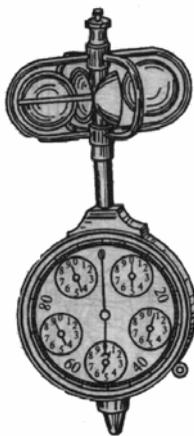
Рисунок 6.7 – Чашечный анемометр
