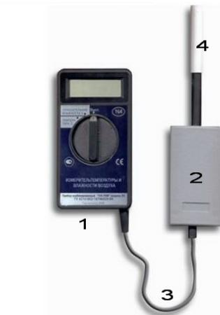
1 – блок обработки сигналов; 2 – измерительная головка; 3 – кабель связи; 4 – защитный колпачок
