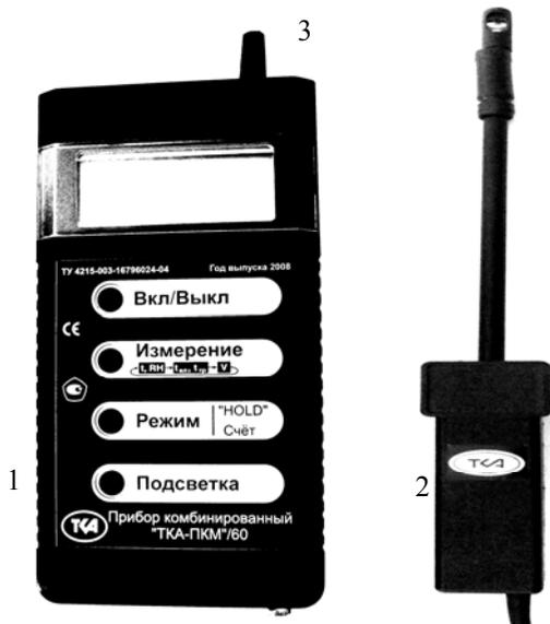
1 – блок обработки сигналов; 2 – измерительная головка; 3 – кабель связи
