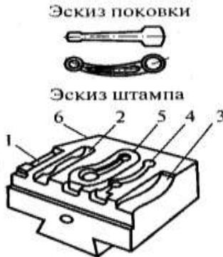
*Рис. 4.7. Стадии получения сложной поковки в нескольких ручьях: 1 – заготовительный протяжной ручей; 2 – подкатной ручей; 3 – гибочный ручей; 4 – предварительный ручей; 5 – окончательный ручей; 6 – отрубной ручей*
