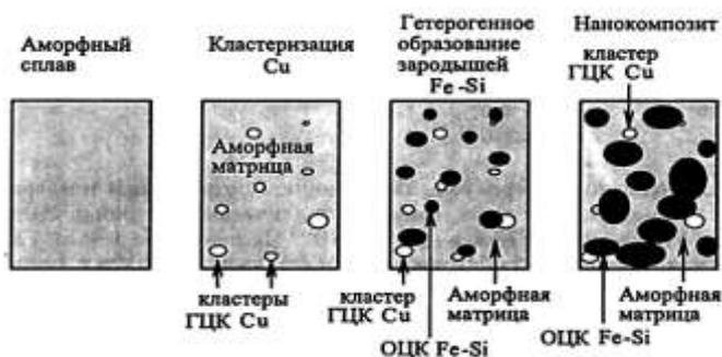
Рис. 11.11. Схема формирования наноструктуры в аморфном сплаве системы Fe-Cu-Nb-Si-B в процессе его кристаллизации
