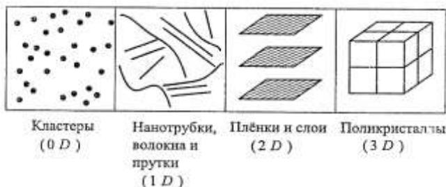
*Рис. 11.3. Типы нанокристаллических материалов: 0D – нульмерные кластеры; 1D – одномерные нанотрубки, волокна и прутки; 2D – двумерные пленки и слои; 3D – трехмерные поликристаллы*
