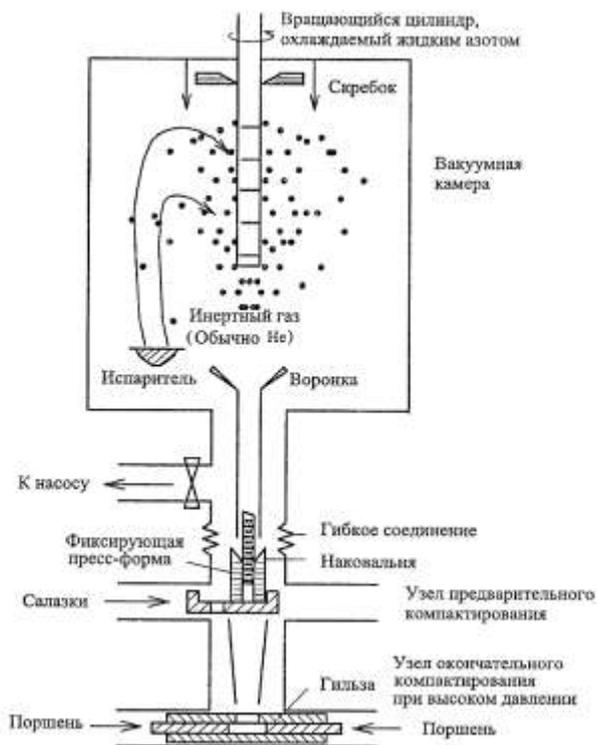
*Рис. 11.9. Схема установки для получения компактных нанокристаллических материалов методом испарения и компактирования*
