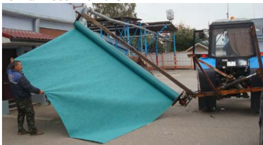
Рисунок 4 – Опытный образец размотчика рулонов укрывочного материала
