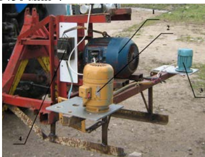
1 – асинхронный генератор; 2, 3 – электродвигатели; 4 – пускатель
