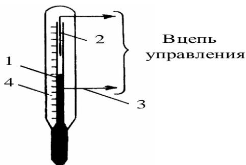
Рис. 5.3. Устройство электроконтактного ртутного термометра: 1 – ртутный капилляр; 2 – подвижный электроконтакт; 3- неподвижный электроконтакт; 4 – шкала температур.
